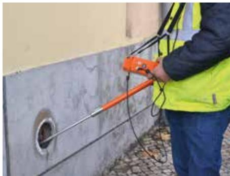
• Deteção de fugas de água
