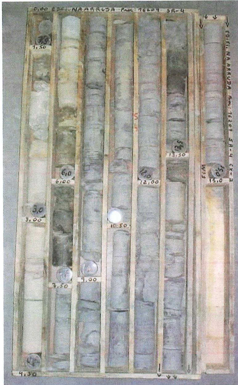
TESTEMUNHO DA SONDAGEM S4 (Caixa 1 de 1)
